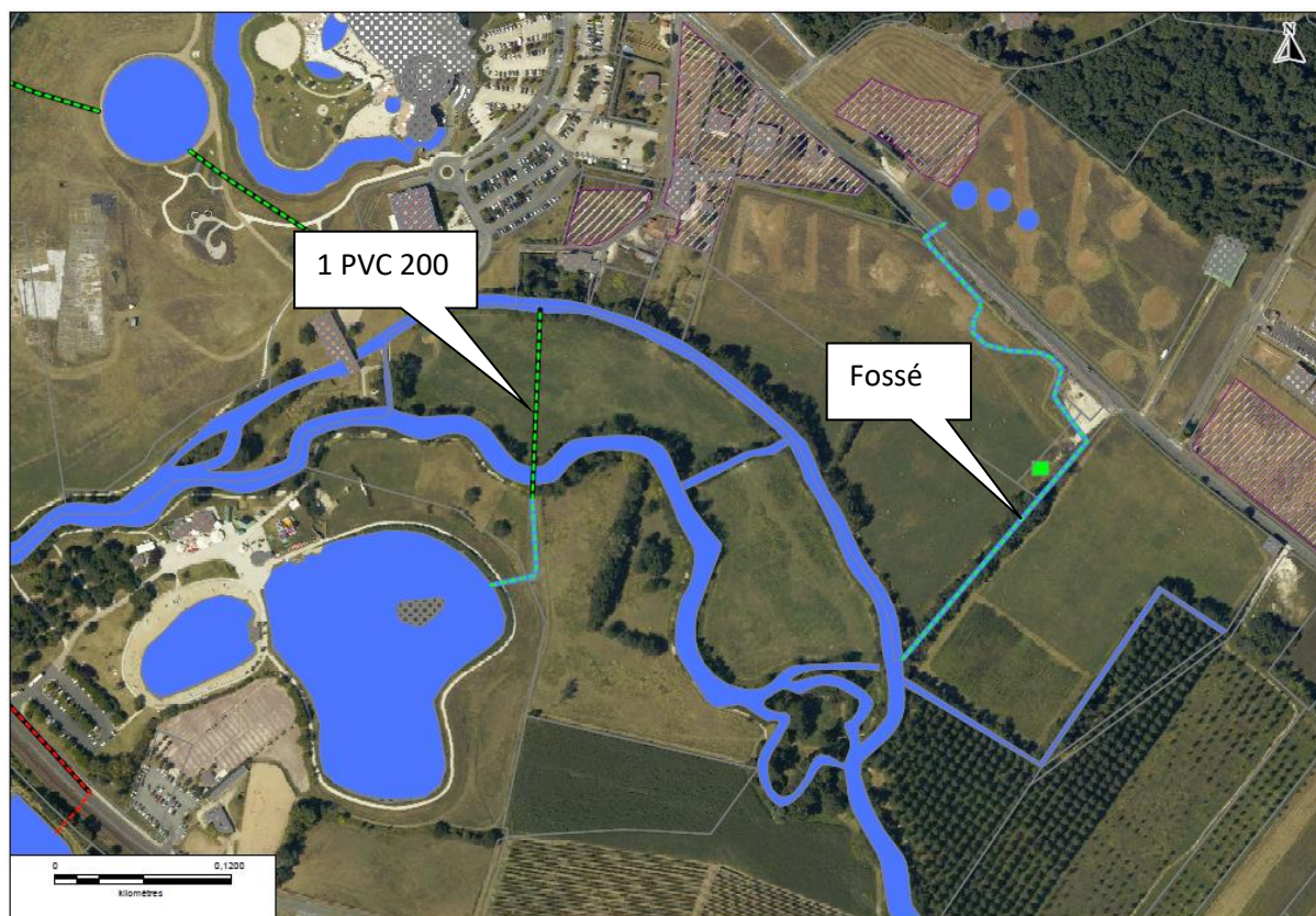
Figure 7 : Vue du rejet des bassins d'Heurtebise et du réseau d'eau géothermique
